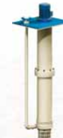
SERIE CV MAG P Centrifugas verticales de arrastre magnético Caudal hasta 120 mc/h Altura hasta 44 m Longitud hasta 5m
