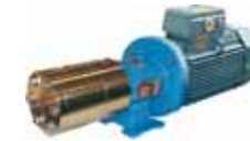
SERIE V MULTIETAPA Caudal hasta 3 mc/h Presión hasta 25 bar
