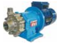
SERIE WA MAG-M Según API 685 Caudal hasta 100 mc/h Altura hasta 80 m
